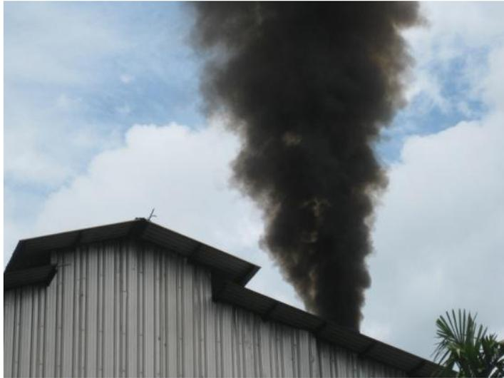
Gambar 4 Asap Hitam pada Cerobong asap Boiler
