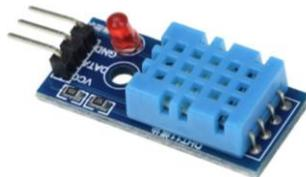
Gambar 1. Sensor Temperatur dan Kelembapan – DHT 11
