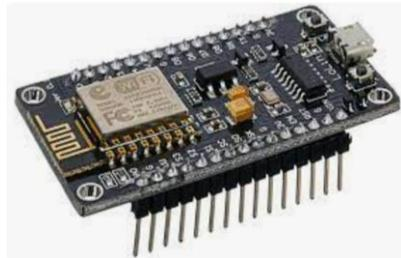
Gambar 2. Mikrokontroler NodeMCU
