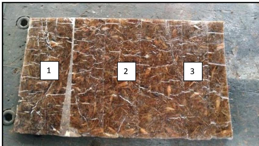
Gambar 2 Benda Kerja dan Posisi Pengukuran Temperatur Benda Kerja
