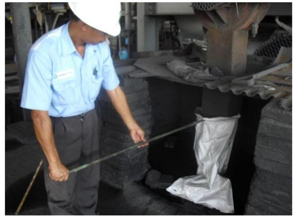
Gambar 2. Proses Pengambilan Abu *Boiler*
