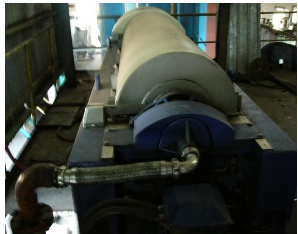
Gambar 1. Alat decanter ( pemisahan minyak secara mekanis untuk pemurnian minyak )
