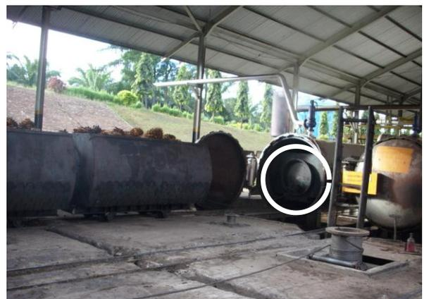
**Gambar 1.** Mekanisme pengeluaran dan pemasukkan lori di sterilizer
