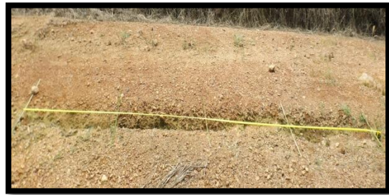
Gambar 1. Pengukuran panjang erosi alur pada jalan koleksi
