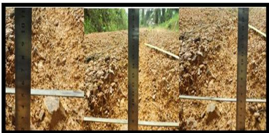
Gambar 4. Pengukuran kedalaman erosi alur pada jalan koleksi
