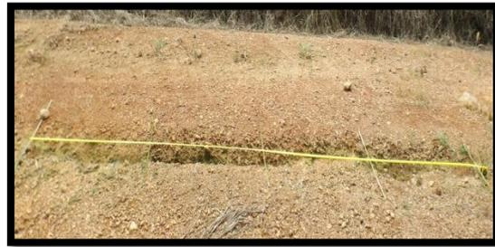
Gambar 1. Pengukuran panjang erosi alur pada jalan koleksi
