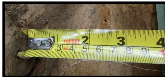
Gambar 2. Pengukuran lebar erosi alur pada jalan koleksi
